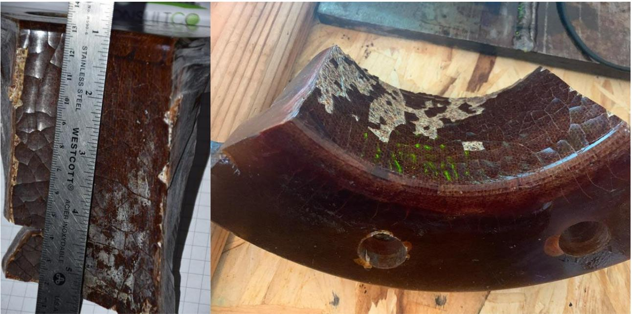
图4. FRP的内表面状况和腐蚀
